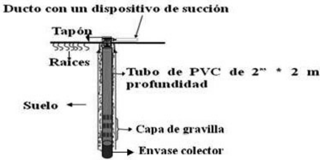
Figura 1. Diseño del Lisímetro para la recolección de los lixiviados por debajo de la zona radical.
